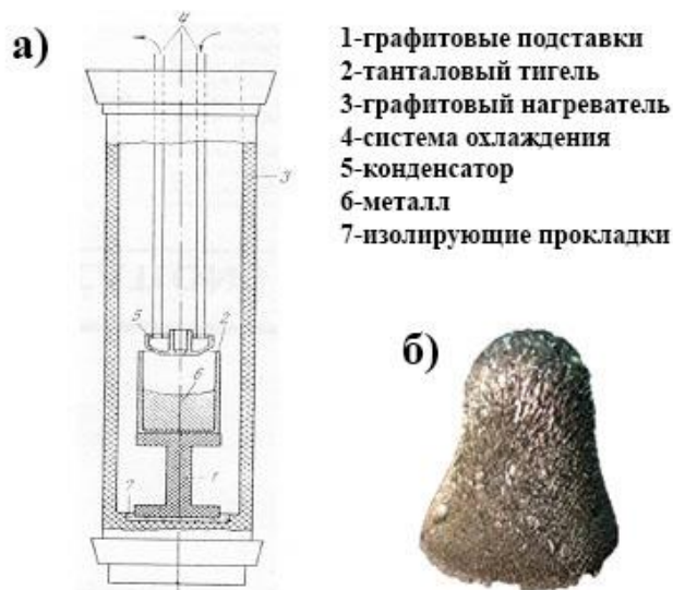
Рисунок 2.1 – Схема печи для дистилляции редкоземельных металлов (а) и внешний вид получаемых дистиллятов (б).
